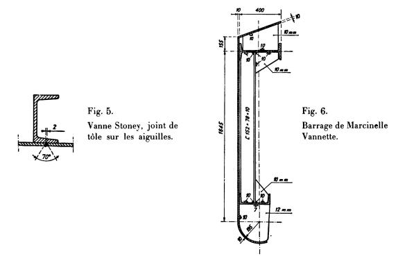
Vannette. — La vannette se compose également de 2 poutres principales horizontales sur lesquelles est soudé le bordage simple en tôle de 10 mm avec raidisseurs en plats et profilés normaux légers.
