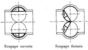
Fig. 5. Soupape cylindrique, contour général
