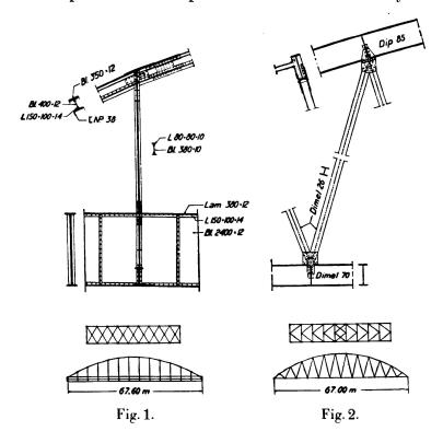
représenté à la fig. 2 (poutre parabolique avec diagonales et sans poteaux). Ce type de poutre, à part quelques exceptions, n'a été que peu employé en construction métallique. Par contre on a exécuté plusieurs fois des systèmes semblables en béton armé sous forme d'arc avec tringles de suspension obliques
