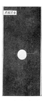
Dauerzugversuch Ursprungsfestigkeit  $\sigma_U = 24.0 \text{ kg/mm}^2$
