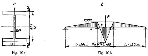
Querschnitt und Belastungsanordnung des Versuchsbalkens von Stüssi und Kollbrunner.
