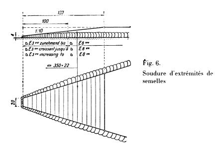
des détails de la construction métallique. Comme on a reconnu la supériorité des joints bout à bout quant à la résistance à la fatigue, l'Ingénieur doit se libérer des principes de la construction rivée et chercher, pour les barres et les noeuds, de nouvelles formes qui permettent d'utiliser partout des assemblages soudés bout à bout.
