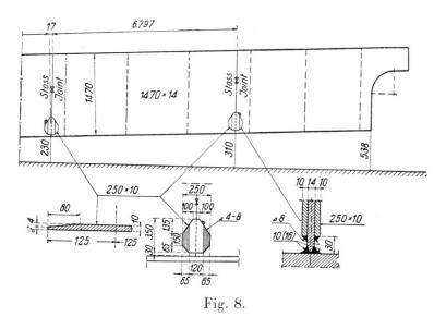
Joint d'âme, pont-rails de la ligne Zürich-Baden C.F.F.
