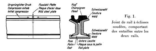
de soudure. Il en résultait un joint suivant la fig. 1, dans lequel l'entaille inférieure était couverte par la plaque dont nous avons parlé; quant à la transition brusque de section entre les champignons, elle a été rendue à peu près sans influence par le fait de la compression initiale engendrée. La transition brusque de section entre les éclisses, respectivement la plaque inférieure et le rail continuait à exister.
