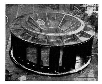
Fig. 2. Rotor de turbine.
