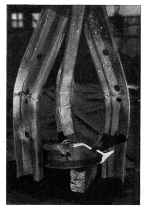
Fig. 6. Rails soudés pliés à froid.
