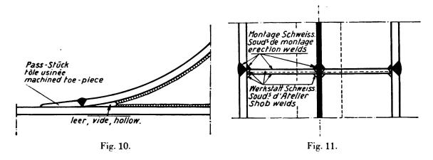
prismatique, en dehors des courbes. Les dimensions des montants et de leurs assemblages sont calculées largement, parce que les taux de travail changent de signe suivant la position des surcharges. Ce sont les pièces les plus fatiguées.
