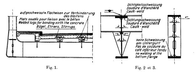
profils composés. Ce sont alors des poutres à âme pleine, dont l'âme est mince et haute. Lors de la soudure des raidisseurs, il faut éviter les tensions internes pouvant provoquer la rupture de l'âme. Un type de raidisseur d'âme est représenté à la (fig. 3).
