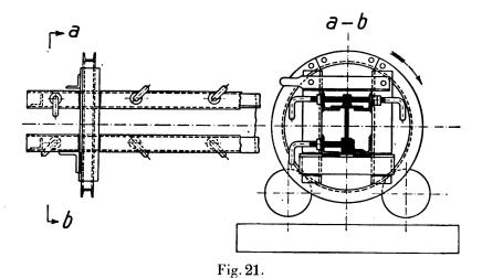
Apparail rotatif pour le soudage des colonnes.
