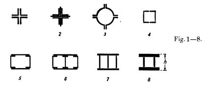
les poutres arquées. Les profilés de laminage permettent déjà un renforcement (ce qui n'est pas du tout le cas dans l'emploi du rivetage), par l'application de couvre-joints, par le découpage et l'accroissement de la hauteur, ainsi que par le soudage de nervures latérales au point d'application de la charge concentrée.
