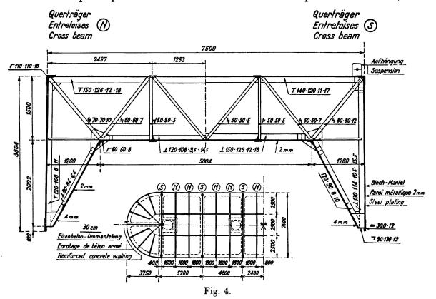
Section de la construction soudée du caisson de fonçage.
