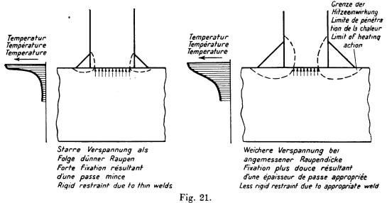
Effet de fixation dans les soudures d'angle.
