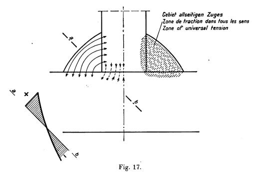
Effet de retrait dans les soudures d'angle.
