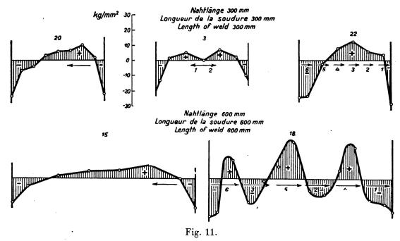
Matériau: St. 37. Epaisseur: 12 mm. Procédé de soudure: à l'arc électrique. Electrodes: Seelen Böhler Elite. Nombre de passes: 3.
