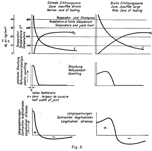
Rapports de température, de refoulement et de contrainte pour des zones chauffées étroites et larges.
