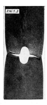
Essai statique de traction; résistance à la traction  $\sigma_B = 54.6 \ km/mm^2$
