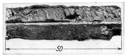
Fig. 7. Soudures à l'arc défectueuses sur acier St. 37; cordons en X.
