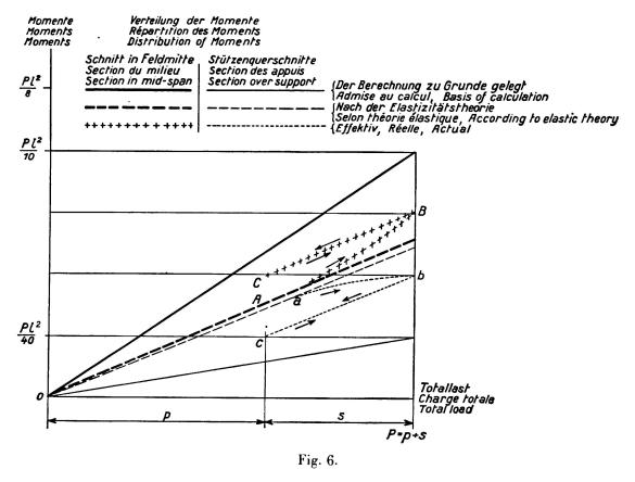
Fatigues aux appuis et au milieu de la portée d'une poutre semi-encastrée.
