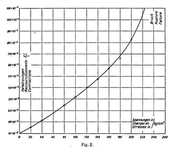
Courbe de déformation du béton de ciment.
