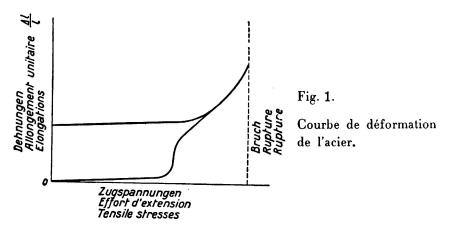
considérable pour une augmentation très faible de l'effort. En diminuant alors jusqu'à 0 l'effort de traction, on constate que l'éprouvette se raccourcit suivant une loi élastique à très peu près identique à celle qui représente la déformation élastique initiale. La barre ainsi traitée est susceptible de fonctionner élastiquement
