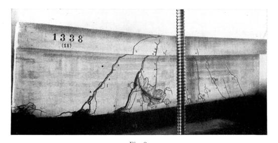
Fig. 3. Poutre de béton armé ayant subi une flexion souvent répétée.
