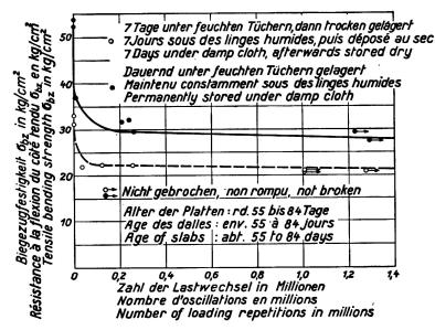
Abmassungen 20×40×170 cm , Auflagerentfernung 150 cm 2 Lasten im Abstand von 50 cm , 6u beim Dauerversuch 4,9-5,2kg/cm² Dimensions 20×40×170 cm , distance des appuis 150 cm 2 charges à la distance de 50 cm , 6u pour l'essai à la fatigue 4,9-5,2kg/cm² Dimensions 20×40×170 cm , distance of supports 150 cm 2 loads 50 cm apart ,6u for fatigue test 4,9-5,2kg/cm²
