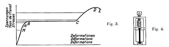
à la fois l'éprouvette et le ressort et il faut connaître l'élasticité de ce dernier pour juger de ce qui se passe dans l'éprouvette. Pour chaque position de la vis, ce point figuratif du diagramme déformations / forces doit être recherché à la rencontre de la courbe *intrinsèque* et d'une courbe exprimant la loi *extrinsèque* qui lie la distance des mâchoires à l'effort qu'elles transmettent.
