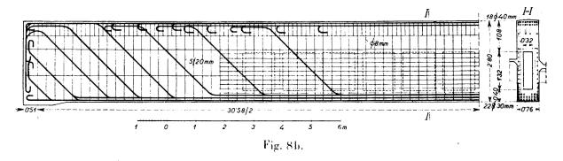
Hauptträger 330 kg/cm². Erreicht wurden bei der Ausführung 334 kg/cm² bezw. 486 kg/cm², wobei der Zementzusatz 250 kg bezw. 420 kg Portlandzement auf 1 m³ trockenes Gemenge von Sand und Schotter und der Körnungsmodul der Zuschlagstoffe 5,70 bezw. 6,30 betrug.
