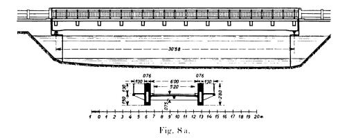
einer zulässigen Eisenspannung von 1200 kg/cm² bemessen. In den Hauptträgern betrugen die größten Spannungen 69,4 kg/cm² (zulässig 70 kg/cm²) bezw. 1662 kg/cm² (zulässig 1800 kg/cm²). Zur Vermeidung von Zugrissen in den Hauptträgern wurden um die Zugbewehrung außer den Bügeln Drahtgewebe eingelegt, welche den Zugwiderstand der Deckschichte vergrößern sollen.
