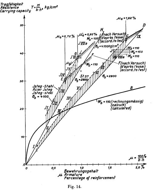
Die Tragfähigkeit von Eisenbetonbalken rechteckigen Querschnitts in Abhängigkeit vom Bewehrungsgehalt nach den Dresdner Versuchen.
