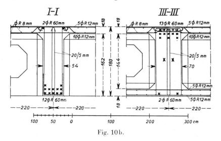
$1,80~\rm m$ , d. h. ungefähr  $^1/_{18}$  der Spannweite der Mittelöffnung bezw.  $^1/_{13}$  der Spannweite des eingehängten Trägers, auszukommen. Um bei Vollbelastung des Mittelfeldes eine 1,4 fache Sicherheit gegen Kippen gewährleisten zu können, wurden die Randfelder in den Teilen, welche nicht durch Leitungen in Anspruch genommen waren, kastenförmig ausgebildet und mit Füllbeton belastet.
