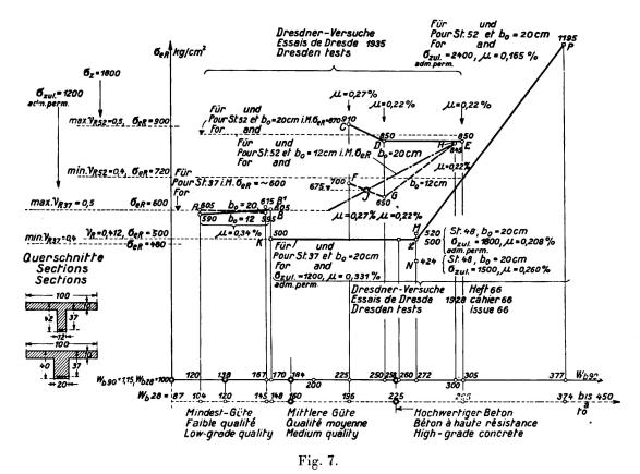
Die Rißspannung  $\sigma_{e R}$  von St. 37 und St. 52 bei Plattenbalken mit  $b_0 = 20$  und 12 cm Rippenbreite in Abhängigkeit von der Würfelfestigkeit.
