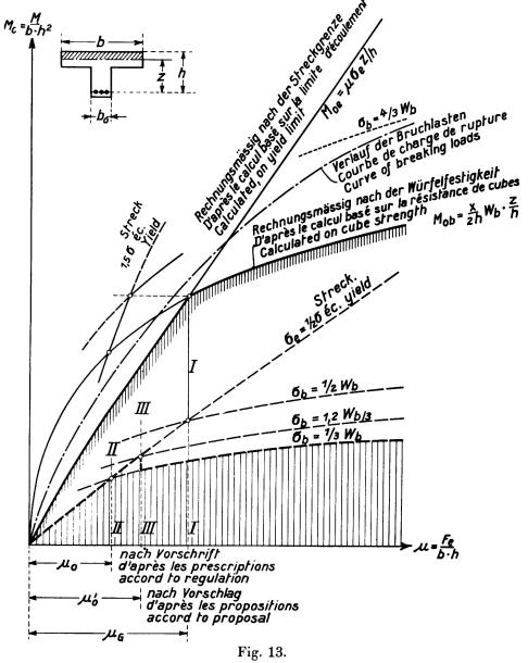
Die Tragfähigkeit von Eisenbetonbalken in Abhängigkeit vom Bewehrungsgehalt (nach Emperger und Haberkalt).
