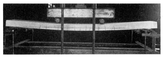
Fig. 18. Platte mit Baustahlgewebe bewehrt (Dresdner Versuche 1934).
