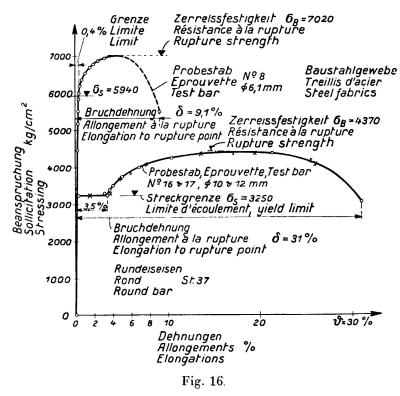
Spannungs-Dehnungslinien von Baustahlgewebe und Rundeisen St. 37.
