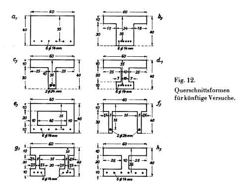
2. Der auffallende Unterschied der größeren Rißbreiten bei  $b_o = 20$  cm gegenüber  $b_o = 12$  cm bildet eine Bestätigung der physikalischen Auffassung (s. unter VI, 1), die in unserer Grundgleichung (28) zum Ausdruck kommt. Bei der gleichen Rißtiefe (z. B. t = 3 cm) verhalten sich in beiden Fällen die beim Auftreten des ersten Risses frei werdenden Beton-Zugkräfte wie die Flächen  $b_o$  t, also
