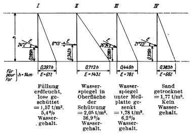
Fig. 18. Erddruckversuche mit künstlichem Grundwasserstand.
