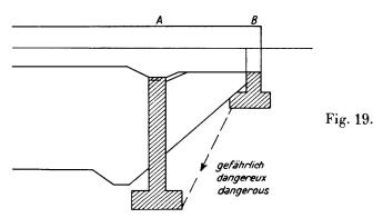
4. Das beabsichtigte Verdichtungsverfahren sollte bereits bei der Berechnung der Endwiderlager einer Brücke berücksichtigt werden. Es ist da große Vorsicht
