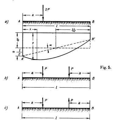
$(y_o=0)$  vorhanden sein. Betrachten wir die Gleichgewichtsbedingungen und setzen wir die Arbeit der inneren Kräfte im Stabe gleich mit dem Zuwachs an potentieller Energie am Auflager, so erhalten wir für den symmetrischen Fall (Fig. 5b) folgenden Ausdruck für die elastische Linie:
