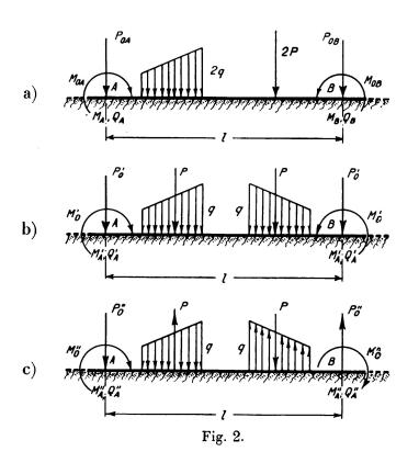
In diesen Formeln sind M'<sub>A</sub>, Q'<sub>A</sub> und M''<sub>A</sub> und Q''<sub>A</sub> Momente und Schubkräfte, die in A aus den symmetrischen bezw. unsymmetrischen Lastkomponenten entstehen und die F-Symbole geben die in Fig. 3 dargestellten Funktionen an:
