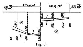
Gleichmäßig verteilte Last a) Sand I, Versuch Eb ( $p_0 \approx 0.5 \text{ kg/cm}^2$ ), b) Sand III, Versuch Ha ( $p_0 \approx 1.0 \text{ kg/cm}^2$ ) T = Gesamteinsenkungen, I = bleibende Einsenkungen.
