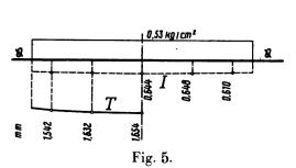
Gleichmäßig verteilte Last auf der Gummilage, Versuch Qa T = Gesamteinsenkungen, I = bleibende Einsenkungen.
