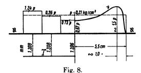
Lastverteilung zum Ausgleich der Einsenkungen. Zum erstenmal belastete Gummilage, Versuch Qh.
