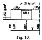
Lastverteilung zum Ausgleich der Einsenkungen. Sand V, Versuch Ng (po  $\approx 0.5 \text{ kg/cm}^2$ ).
