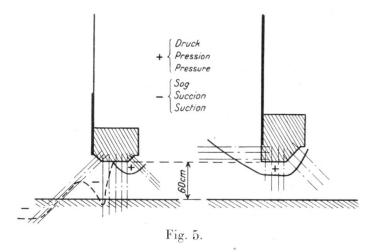
holzbalkens die Ursache dieser Schwingungen bildet und man diesem Übel durch entsprechende Ausbildung abhelfen kann (Fig. 5). Auch hier kommt es darauf an, eine positive und stabile Drucklinie zu erhalten.
