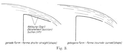
stab 1:5 über die Formung der Bleche gemacht und eine gekrümmte Form ermittelt, wie sie rechts zu erkennen ist. Die ursprüngliche schräge Form zeigte nämlich einen ganz unregelmäßigen Druckverlauf und zahlreiche Sogstellen. Beides jedoch, Unregelmäßigkeiten im Druckverlauf und Sogwirkungen, ist im
