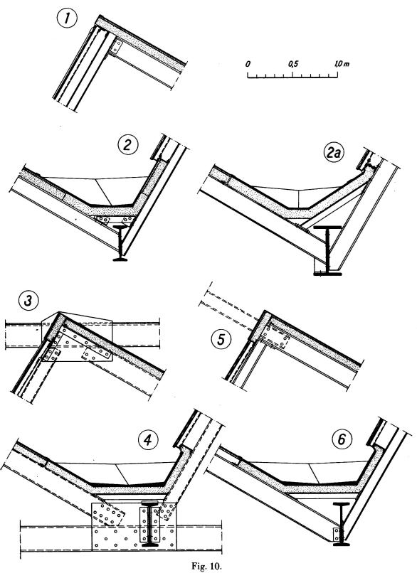
Einzelheiten des Traggerippes und der Anordnung der Dachhaut zu Fig. 8 und 9. (Linke Dachfläche in 6 sollte wie in 4 durchgehend punktiert sein).
