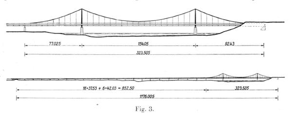
Damit schließt sich der Kreis, die Bogenbrücke wird zur Hängebrücke, die Hängebrücke zum Fachwerkträger, der Fachwerkträger zur Bogenbrücke. Obwohl die weit gespannte Bogenbrücke und auch die Hängebrücke nicht zur Ausführung gelangten, glaube ich, daß sich Gelegenheit finden wird, aus den alten Entwürfen Anregungen zu schöpfen und in ähnlichen Fällen solche Systeme zu verwenden.
