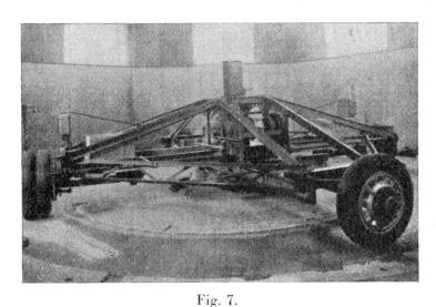
Rundlauf zur Prüfung von Fahrbahnbeläge auf Flachblechen.
