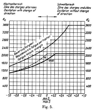
Zulässige Beanspruchungen nach BE "Berechnungsgrundlagen für stählerne Eisenbahnbrücken" (starker Verkehr) und Dauerzugfestigkeit für genietete Stäbe aus St. 52/14. Kurve a gilt, wenn max S eine Druckkraft ist.
