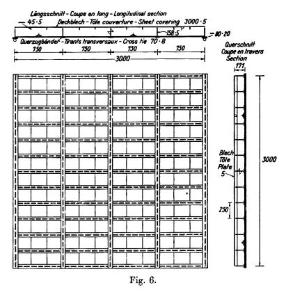
Prüfkörper. Versuche mit Trägerrostplatten.
