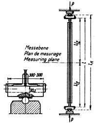
l = Stablange - Longueur de la barre-Length of test piece l<sub>K</sub> = Knicklänge - Longueur de flambage - Buckling length
