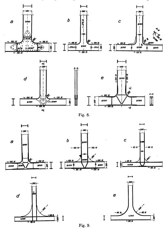
Querschnitt und den Aufbau des Trägers. Wenn man zunächst die Stegbleche für sich allein zusammenschweißt und dann erst die Flanschen anfügt, kann dieser Träger praktisch ohne Schweißspannungen aus äußerer Verspannung
