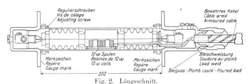
Die Saite wird mittels eines Elektromagneten erregt, in den der Entladestrom eines kleinen Kondensators geleitet wird. Dieses gewissermaßen elektrische Anzupfen versetzt die Saite in Schwingungen, die über denselben Stromkreis mittels eines Röhrenverstärkers wahrgenommen werden (Fig. 3), wobei der
