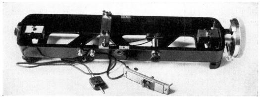
Fig. 4. Vergleichsapparat zur Bestimmung der Frequenzen.
