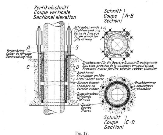
Schema der Einrichtung für die Pfahlversenkung.
