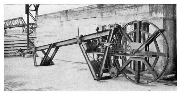
Fig. 6, Maschine zur Erhöhung der Streckgrenze der Stähle.
