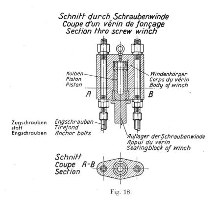
Detail einer Schraubenwinde.
