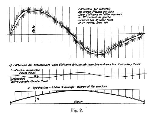
Fig. 2 zeigt den Verlauf der Einflußlinie, die wir auf diese Weise erhielten. Fig. 2a gibt die Einflußlinie der Nebenschübe wieder.
