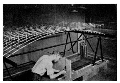
Fig. 4. Räumliches Modell. Messung der lotrechten Verschiebungen.
