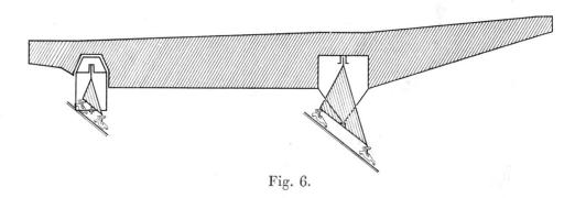
raumförderbrücken (Fig. 6) sind Beispiele. Die Trägerachse läßt sich nach Patenten der Mitteldeutschen Stahlwerke bis zu  $45\,^{\rm o}$  gegen die Fahrtrichtung verschwenken.
