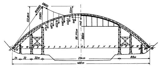
Fig. 8. Kräfte für ein Tragkabel.
