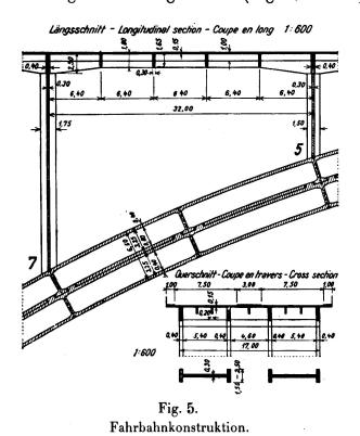
Er besteht darin, daß der Hauptbogen als Doppelbogen aus zwei gleichen, übereinander liegenden Einzelbogen besteht, wobei der untere auf einem Gerüst hergestellt wird. Dieser fertige Bogen wird nach einem Ausrüstungsverfahren freigemacht, wobei mittels hydraulischer Pressen die tunlichste Ausschaltung der Schwindspannungen und der Senkungen infolge der plastischen Verformung vorher bewirkt wird.
