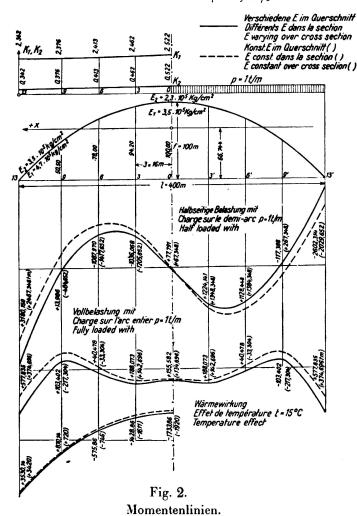
Für Vollbelastung mit 1 t/m Kämpfermoment das (gegenüber + 577,835 tm374,696 tm für E = konst.) $\Delta = 54$  %. Die bezüglichen Momentenlinien sind in Fig. 2 gegeben. In dieser Figur sind die Momentenlinien für veränderliches E voll ausgezogen, für ein durchwegs konstantes E strichliert. Auch die veränderlichen Größen k<sub>1</sub> und k<sub>2</sub> sind in der Figur gegeben. Die Momente für die Wärmewirkung von t= 15°C sind ermittelt und in tm eingetragen. Hier sind die Unterschiede geringer.
