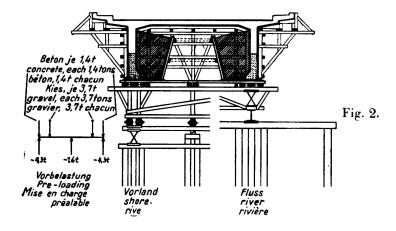
meinem Entwurf ausgeführten Reichsautobahnbrücke über den Inn angewandt und insgesamt über 1000 lfdm Träger nach dieser Methode betoniert (Fig. 2). An der Innenseite der Trägerschalung waren Kästen angeordnet, welche den zur Belastung verwendeten Kies aufnahmen. Hiedurch wurden rund zwei Drittel der Betonlast erzielt. Bis zur Erreichung der Vollast waren noch rd. 0,6 cbm/m
