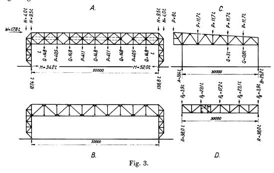
In sehr großem Maße hat man bei der Bestimmung der Profile auf die Verwendung von einfachen T-Querschnitten zurückgegriffen, die durch Zerschneiden von gewöhnlichen Walzträgern mit dem Schneidbrenner erhalten wurden.
