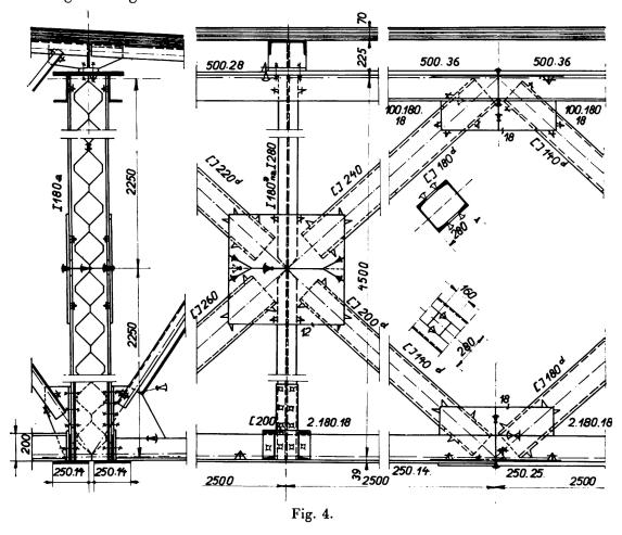
Sämtliche Träger sind an der Baustelle nach Möglichkeit flachliegend verschweißt worden; dann wurden sie sogleich in ihre endgültige Lage gebracht und die letzten Schweißnähte sind in der senkrechten Lage fertiggestellt worden. Die Montageschweißungen sind aus diesem Grunde im Hinblick auf die Lage, in der sie ausgeführt werden mußten, durchdacht und an leicht zugängliche Stellen verlegt worden.
