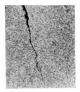
Fig. 4. Mikroriß im Schweißgutgefüge, röntgenographisch nicht feststellbar.
