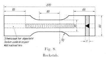
Wenn die Schweißnaht nicht verletzt werden soll, muß eine der zerstörungsfreien Prüfarten gewählt werden. Hierzu kann auch der äußere Befund gerechnet werden, der dem Kundigen Rückschlüsse auf die Güte der Naht gestattet. Im Behälterbau sind Wasserdruck-, Luftdruck- und Dampfdruckversuche möglich. In Sonderfällen sind derartige Untersuchungen, jedoch zerstörend, als Spreng-
