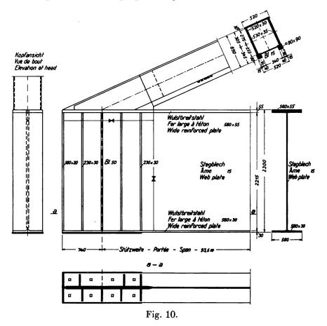
Stabbogen und den einwandigen Versteifungsträgern ein Schmiedestück zwischengeschaltet, das mit einem starken Ansatz in den Versteifungsträger hineingreift und mit dem Stegblech und der geschlitzten Gurtplatte desselben in einfachster und bester Weise ohne Schrumpfspannungen aus äußerer Verspannung verschweißt worden ist. Auf dieses Schmiedestück setzt sich der doppelwandige Stabbogen auf. Ich glaube, diese Ausführung spricht für sich selbst, so daß nicht viel dazu zu sagen ist.
