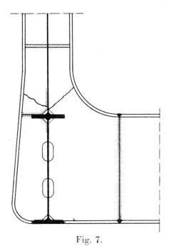
Charakteristische Risse in den Pfosten kreuzförmigen Querschnittes von Vierendeelbrücken.
