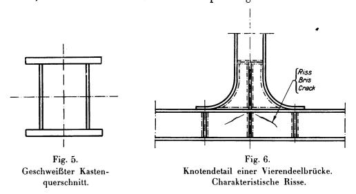
Das Anbringen von Löchern kann ein Walzeisen für die Schweißung ungeeignet machen, da durch den Bruch der gehämmerten Zone Rißbildung und Zerstörung der gesunden Teile des Stückes eintritt.
