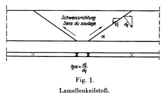
der Schrägschnitte abgeleitet. Bei Schweißrichtung von der schmalen zur langen Seite des Keiles heben sich die Schrumpfungskomponenten in Längsrichtung auf und addieren sich in Querrichtung, so daß die Lasche gleichsam in die Verbindung hineingezogen wird. Vorversuche mit dünnen Platten bestätigten die Annahme.
