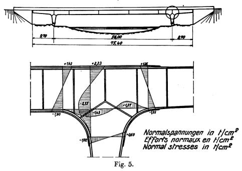
Statische Spannungen einer Rahmenecke.
