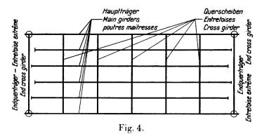
Schrumpfung der Hauptträger bei einer Rostbrücke.
