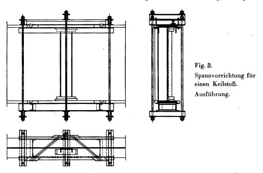
Entwurf einer Verspannung; Fig. 3 gibt wieder, wie stark sie bei der Schweißung zur Bekämpfung der Winkelschrumpfung ausgebildet werden mußte. Bei Trägern aus St. 37 konnten die Nähte durchweg die notwendigen Schrumpfungen rissefrei
