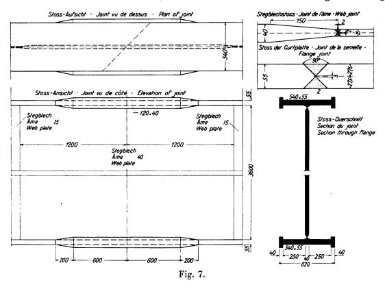
spannungen aus dem Schweißvorgang her eine Druckspannung als Vorspannung hat und umgekehrt. Als Beispiel sei auf den in der Fig. 7 dargestellten Stoß der Blechträger für die Brücke über den Strelasund im Zuge des Rügendamms verwiesen. Es handelt sich dabei um geschweißte durchlaufende Balken auf 6 Stützen über 5 Öffnungen von je 54 m. Nach genauen Messungen des
