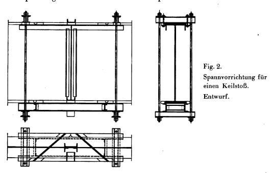
sichtigte Wirkung bald übertönte. Nach Füllen der Nähte bis zwei Drittel der Gesamtstärke tritt starke Winkelschrumpfung ein, die durch immer stärkeres Verklemmen der zu verbindenden Teile bekämpft werden muß. Fig. 2 zeigt den
