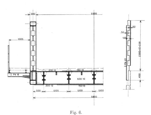
Die Balkenlage besteht aus Walzträgern des bekannten Typs Alpha, überdeckt mit einer Eisenbetonplatte.
