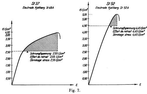
Dehnungsdiagramme bei der Messung von Schrumpfspannungen.
