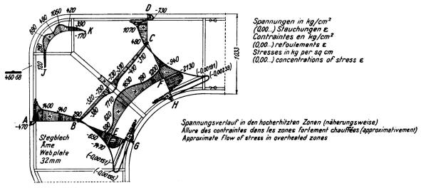
Fig. 12. Messung der Schweiß-Spannungen bei der Herstellung.
