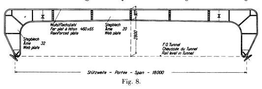
Staatl. Materialprüfungsamts in Dahlem ist ein Schweißvorgang gefunden worden, bei dem die aus Eigengewicht und Verkehrslast am höchsten auf Zug beanspruchte Gurtung im Mittel eine Vorspannung von rd. 300 kg Druck hatte. Das verstärkte Stegblech stand im mittleren Drittel unter einer Vorspannung von etwa 350 kg Zug.
