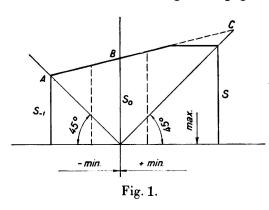
Die Linie ABC soll eine graphische Darstellung zulässiger Spannungen sein, die so angelegt ist, daß jedes Minimum eine Abszisse und das entsprechende Maximum die entsprechende Ordinate ist. So ist bei A, min. = max., und bei der Ordinate  $S_{-1}$  die auf Grund der Prüfungsangaben gewählte Spannung im Falle voller Umkehr zulässig. So ist bei B, min. = 0, und bei der Ordinate  $S_0$  die gewählte Spannung im Falle der Schwingung von Null zulässig.
