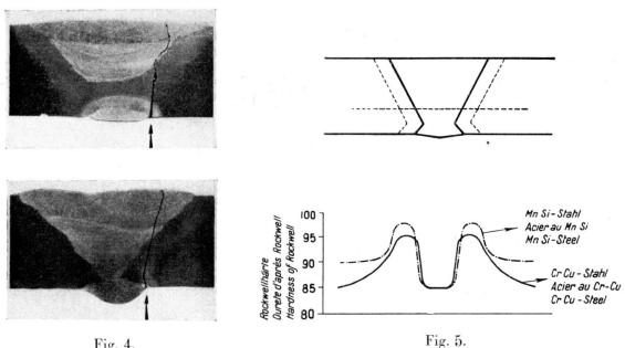
Fig. 4.Einlnitung des Dauerbruches an den Rand der Gegenraupe.
