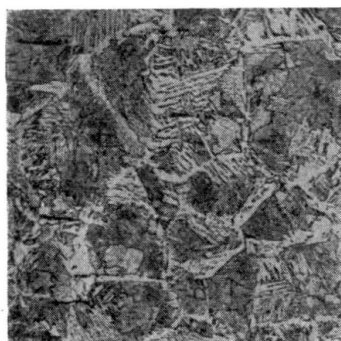
Thermisch verändertes Gefüge. Ferrit und Sorbit. Übergangszone.
