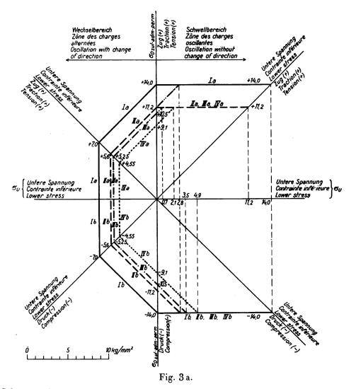
Schaubild der zulässigen Spannungen od zul bei geschweißten Brücken aus St. 37.
