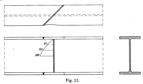
Außer den Schrumpfungen in der Schweißnaht selbst treten auch in den benachbarten Zonen zu beiden Seiten der Schweißnaht während des Schweißvorgangs Ausdehnungen und nach Beendigung Schrumpfungen auf. Diese können nicht durch zusätzliches Erwärmen herabgesetzt werden; Vor- und Nachwärmen kann bestenfalls nur einen Spannungsausgleich bringen. Durch bewegliche Lagerung ist ein ungehindertes Ausdehnen während des Vorwärmens und ungehindertes Nachkommen während des Schrumpfens sicherzustellen.
