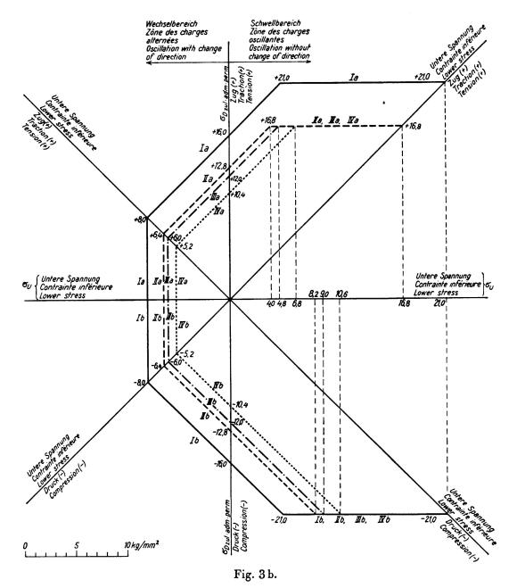
Schaubild der zulässigen Spannungen od bei geschweißten Brücken aus St. 52.
