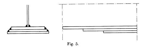
(Fig. 5). Diese Anordnung ist baulich nicht einwandfrei, weil dabei nur die innere Gurtplatte des Paketes an das Stegblech angeschlossen wird, da die Verbindung von breiten Platten durch außenliegende Kehlnähte ungenügend ist und weil beim Schweißen der Kehlnähte die breiten Platten sich wölben und dadurch die Gefahr des Ausbeulens in der Druckzone erhöht wird. Diese Mängel werden gemildert, wenn Gurtplatten verschiedener Dicke angeordnet und mit
