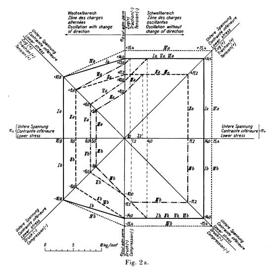
Schaubild der zulässigen Spannungen od zul bei geschweißten Brücken aus St. 37.
