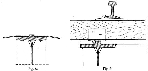
Für die Gesamtwirkung der geschweißten Vollwandträger sind noch die Aussteifungen der Stegblechwände von Bedeutung. Zur Aussteifung hoher Trägerwände werden einfache Bleche, T- oder I-Profile verwendet. Auf das Versetzen
