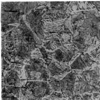
Thermisch verändertes Gefüge. Ferrit und Sorbit. Übergangszone.
