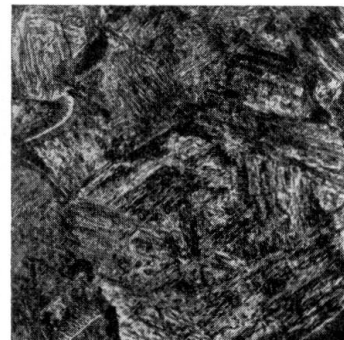
Temperatur: 50° C Martensit, wenig Troostit, Spuren Ferrit.
