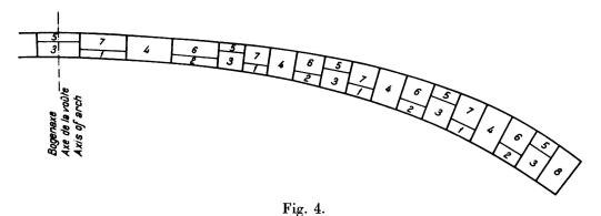
Betonierungsfolge der Lamellen.
