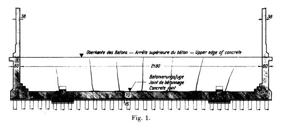
Risse aufgetreten waren. Eine schnelle Arbeitsfolge und damit eine möglichste Verhinderung des Schwindens der bereits betonierten Teile sind absolut anzustreben.
