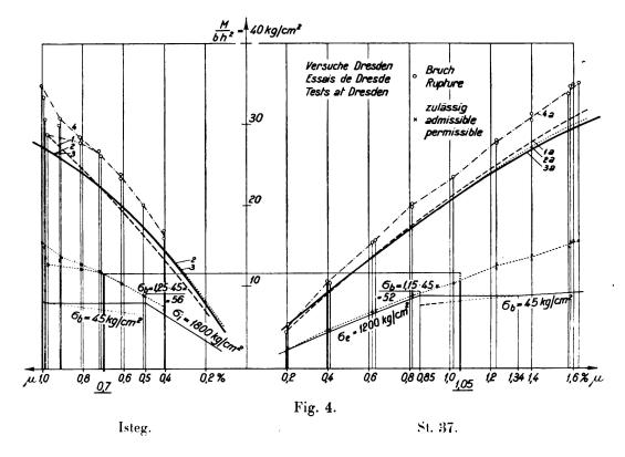
geführten Serie von Vergleichsversuchen aufgetragen, bei der absichtlich die denkbar geringste Würfelfestigkeit von 110 kg verwendet wurde, u. zw. wurden die verlangten vorgeschriebenen Mindestwürfelfestigkeiten von 160 kg/cm² auf  $^2/_3$  reduziert, entsprechend einer zweifachen Sicherheit im Eisen und einer drei-
