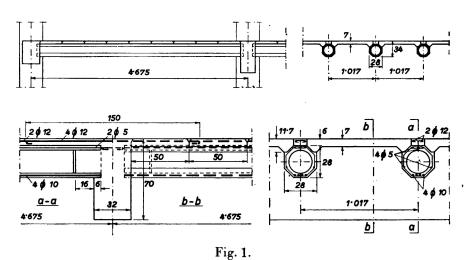
Die Rohre wiesen drei verschiedene Formen auf und zwar: 1. eine Achteckform nach Fig. 2 a mit einer Konstruktionshöhe von 28 cm, 2. die gleiche Form mit einer Konstruktionshöhe von 22 cm, 3. eine polygonale Form mit einer Verbreiterung in der Zugzone nach Fig. 2 b. Einzelne Rohre, bei denen größere Einzellasten zu gewärtigen waren, erhielten an den Laststellen und an den Auflagerpunkten Querversteifungen zur Verhinderung vorzeitiger Zerstörung durch Rohrbruch.
