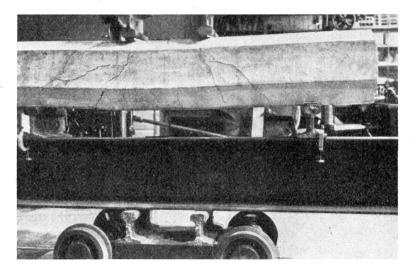
Fig. 5. Kombinierte Schub- und Rohrbruchrisse.
