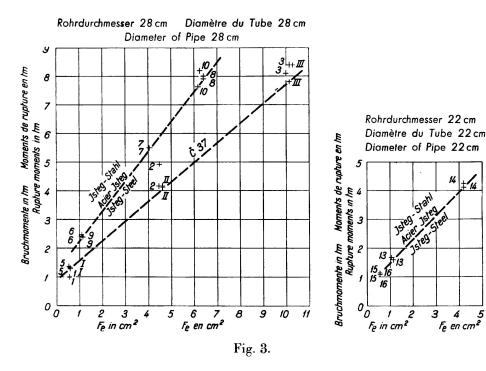
In der Übersicht ist vor allem die große Gleichmäßigkeit (die geringe Streuung) der Versuchsergebnisse auffallend und dies nicht nur bei den einzelnen gleichartigen Balkenpaaren sondern auch in dem gleichmäßigen Anwachsen der Bruchmomente mit den zugehörigen Bewehrungsgrößen.
