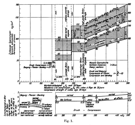
Schweizer Eisenbetonverordnung vom 14. Mai 1935. Zulässige Spannungen des Betons und Bewehrungsstahles in Abhängigkeit von der Betondruckfestigkeit sowie von der Streckgrenze des Bewehrungsstahles.
