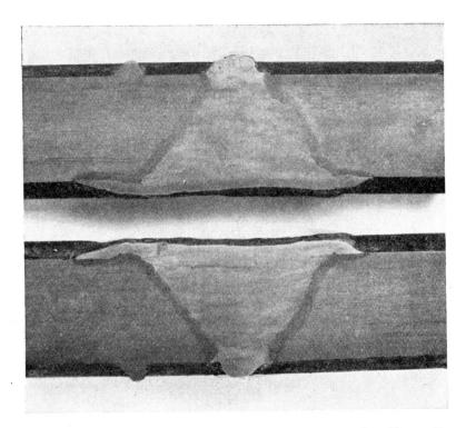
Fig. 7. Geschliffener und geäzter Längsschnitt durch einen geschweißten "Roxor"-Stab.
