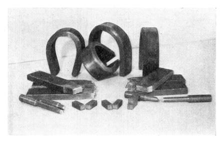
Fig. 2. Schweißnahtproben.
