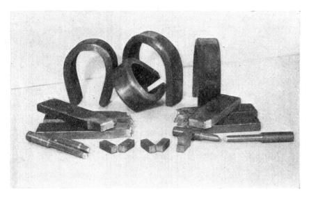
Fig. 2. Schweißnahtproben.
