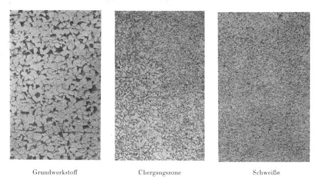
Fig. 8. 100-fach vergrößertes Gefügebild eines geschweißten "Roxor"-Stabes.
