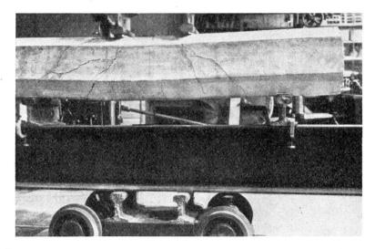
Fig. 5. Kombinierte Schub- und Rohrbruchrisse.
