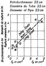
In der Übersicht ist vor allem die große Gleichmäßigkeit (die geringe Streuung) der Versuchsergebnisse auffallend und dies nicht nur bei den einzelnen gleichartigen Balkenpaaren sondern auch in dem gleichmäßigen Anwachsen der Bruchmomente mit den zugehörigen Bewehrungsgrößen.
