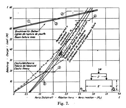
Rahmen-Versuch RMF. 3. (Bruch des Stahles). Horizontale Stützkraft. Beton mit Tonerde-Zement-Mischung 1:2:4 (in Gewicht). Wasser-Zementfaktor = 0,60 (in Gewicht). Alter beim Versuch: 4 Monate. Würfelfestigkeit des Betons 11 000 lb/in².
